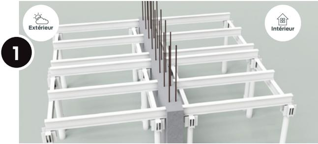
Pose des nappes de treillis inférieures.
