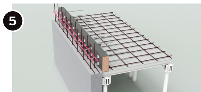
Installation du treillis chapeau et fermeture de dalle
