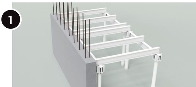
Pose de la nappe de treillis inférieure. Installation du capot h.
