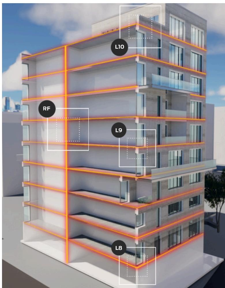
Les principaux ponts thermiques sont localisés sur les liaisons en façade des bâtiments
