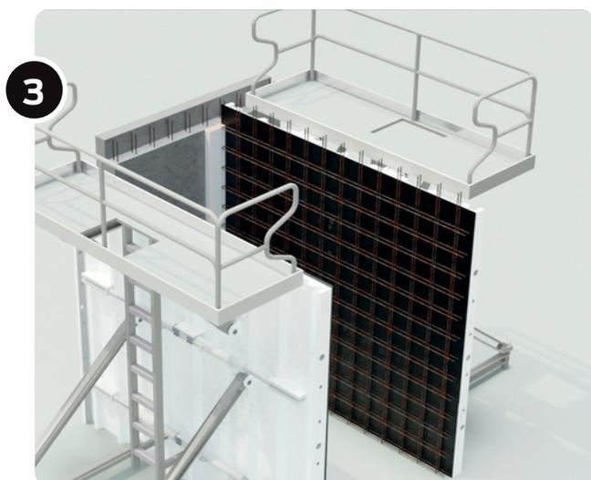
Coulage du béton et décoffrage des banches.
