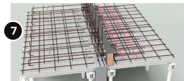
Coulage de la dalle de balcon et de la tête de voile, puis coulage de la dalle de plancher.
