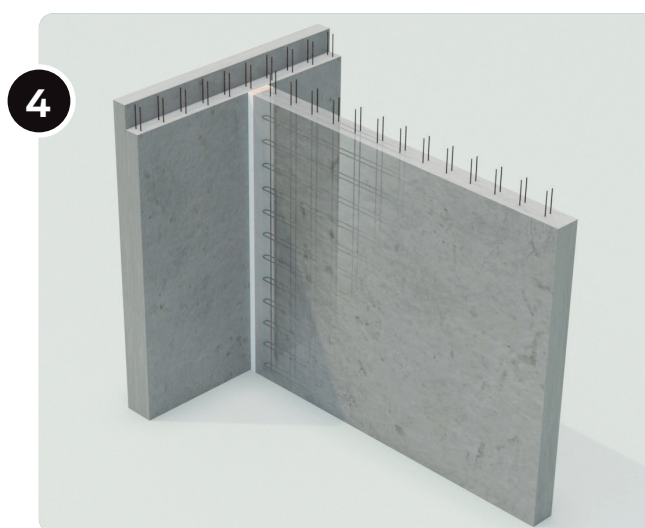
Coulage du béton et décoffrage des banches.
