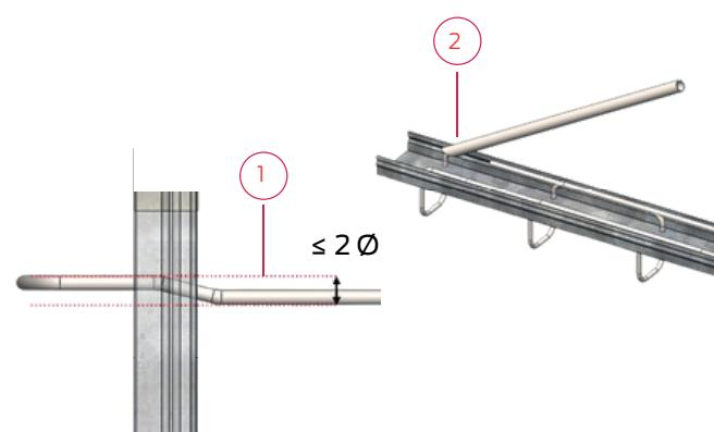
1 Le redressage des aciers doit limiter l'effet baïonnette à maximum 1x le diamètre de l'acier.
