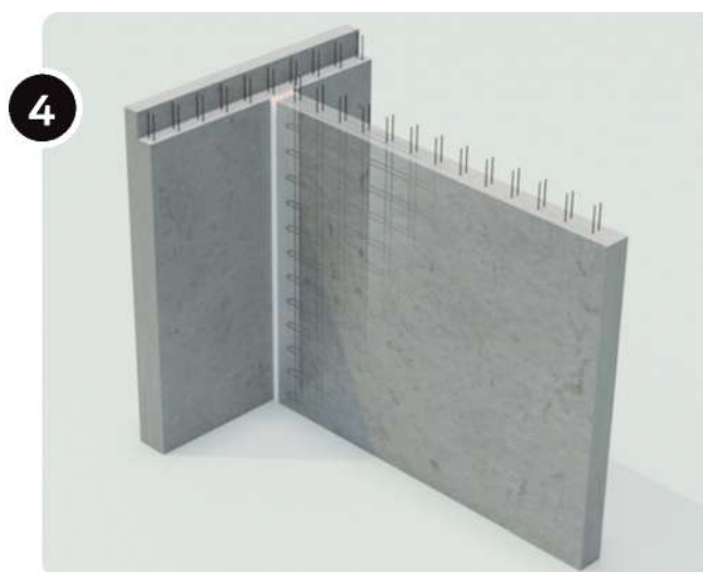
Coulage du béton et décoffrage des banches.
