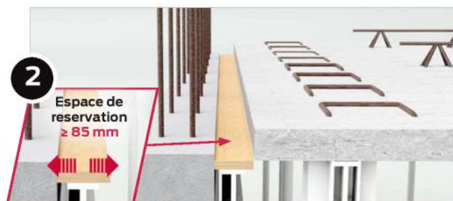
Dépliage des suspentes, pose de filants en tête de voile et en nappe inférieure selon BE.
