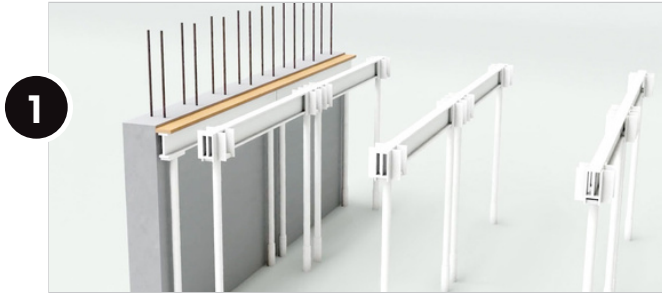
Installation de la prédalle. Suspentes décalées par le préfabricant.
