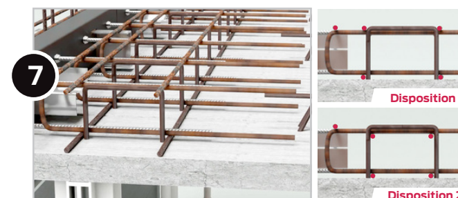
Installation du treillis de chapeau et fermeture de dalle selon BE.
